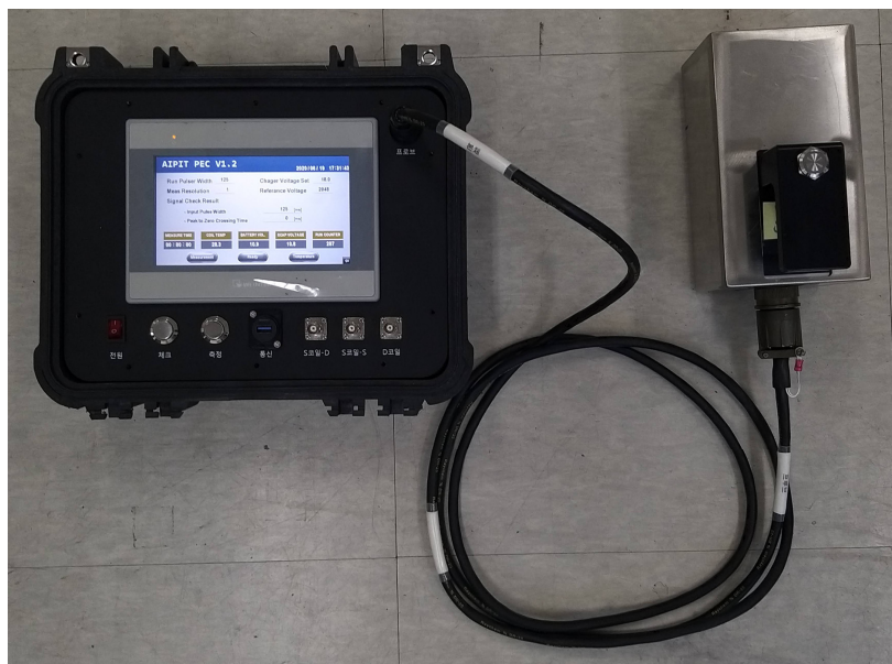
그림 1. 배관의 감육을 측정하는 펄스와전류 시스템
